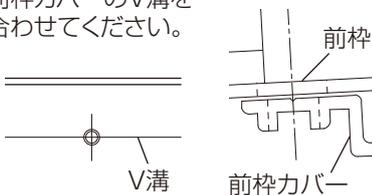
前枠と前枠カバーに隙間があると、前枠加工穴中心と前枠カバーV溝が合いません。
