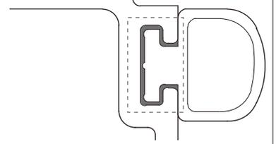
②先に取付けた屋根材の切り欠き部にシーリングしてください。
