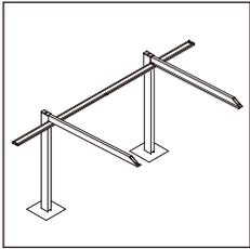
①柱キャップを【8-3】で取り付け、シーリングしてください。
