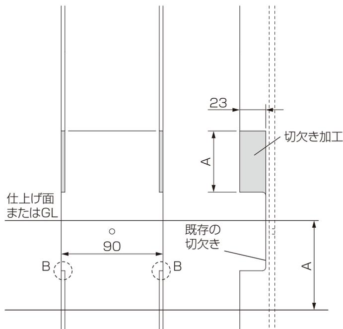
※B部分がGLより上になる場合は、既存の切欠きの角が露出しますので、切り落とすか基礎の中に埋める等の処理をしてください。
