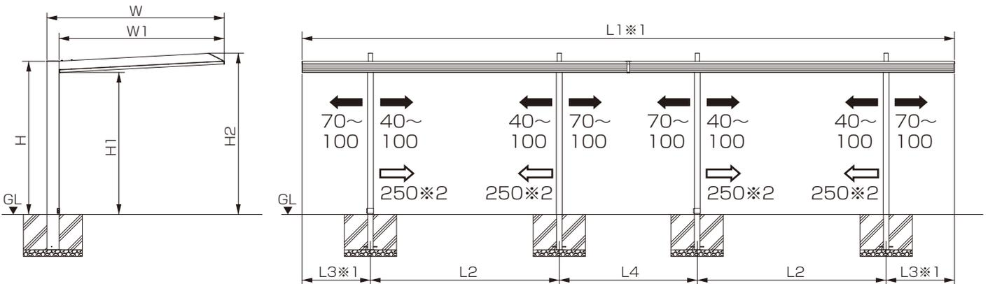
※1:照明用側枠を使用する場合、片側のみ使用は+14.5mm、両側使用は+29mmしてください。
