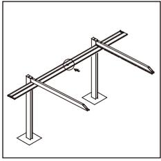
①後枠固定金具を後枠に【9-2】で取り付けてください。
