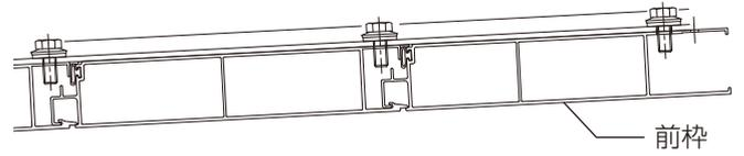
柱移動でネジと梁が干渉するときは、既存穴近くでネジ固定してください。
