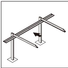
①屋根材(1枚)を後枠に引っ掛け、裏板と【8-1】で仮固定してください。
