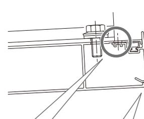
隙間が生じないように、押し付けてネジ止めしてください。
