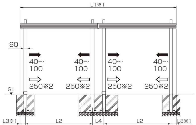
※1:照明用側枠を使用する場合、片側のみ使用は+14.5mm、両側使用は+29mmしてください。
