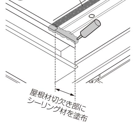
④基本タイプ**8**～**11**(P.24～27)の施工方法を参照し、屋根材～前枠を取付けながら【11-2】で連棟部材を取付けてください。
