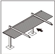
①屋根材同士を引っ掛け裏板と【8-1】で屋根材4枚目までを仮固定してください。
