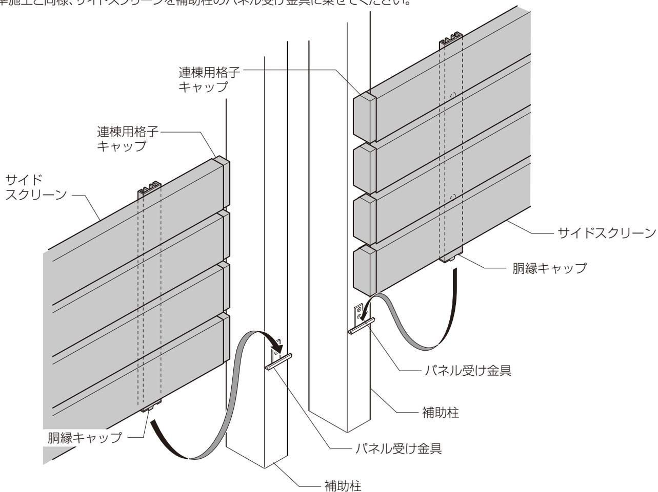
④サイドスクリーンを本体柱のスクリーン取付材および補助柱に【5-1】で固定してください。
