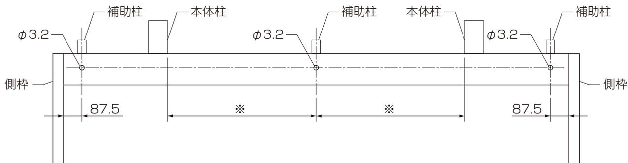
※本体柱と本体柱の間が補助柱になる場合、本体柱内寸の中心に $\phi 3.2$ の下穴をあけてください。
