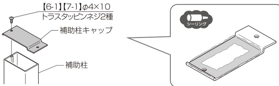
③後枠、前枠に、補助柱キャップの穴を使い写し穴で下穴をあけて、各ねじで取り付けてください。
