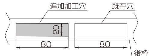
※造り付けバルコニー屋根タイプの場合は、雨樋穴ふさぎキャップの加工が異なります。詳細は、本体取説<MAN-722>を参照してください。
