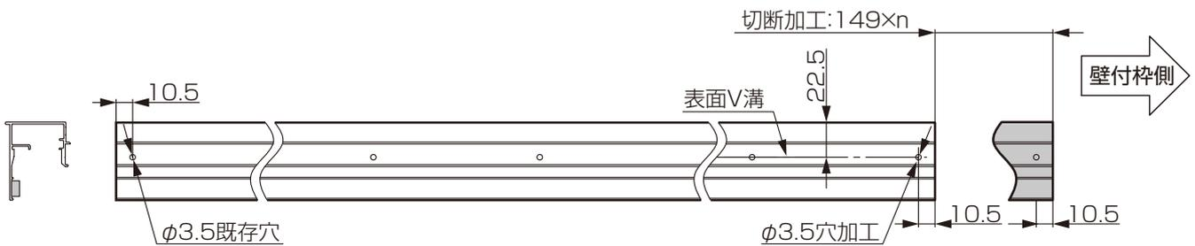
※側枠カバーは【側枠長さ】に合わせて、切断加工してください。
