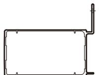
※ 〈壁付タイプ〉の7尺・9尺・躯体出幅7.5尺・躯体出幅9尺の場合、梁にスリーブ取付け穴加工が必要です。
