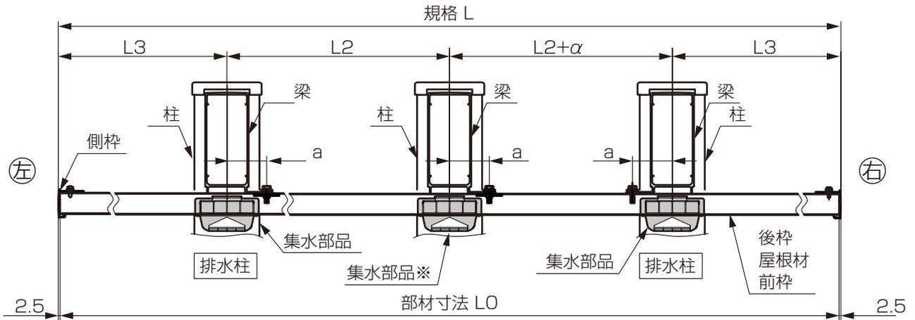
※中央の柱へ集水部品取付けは3台用のみ。
