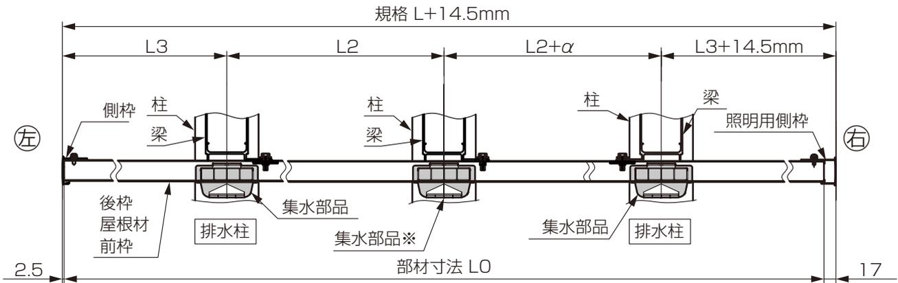
※中央の柱へ集水部品取付けは3台用のみ。
