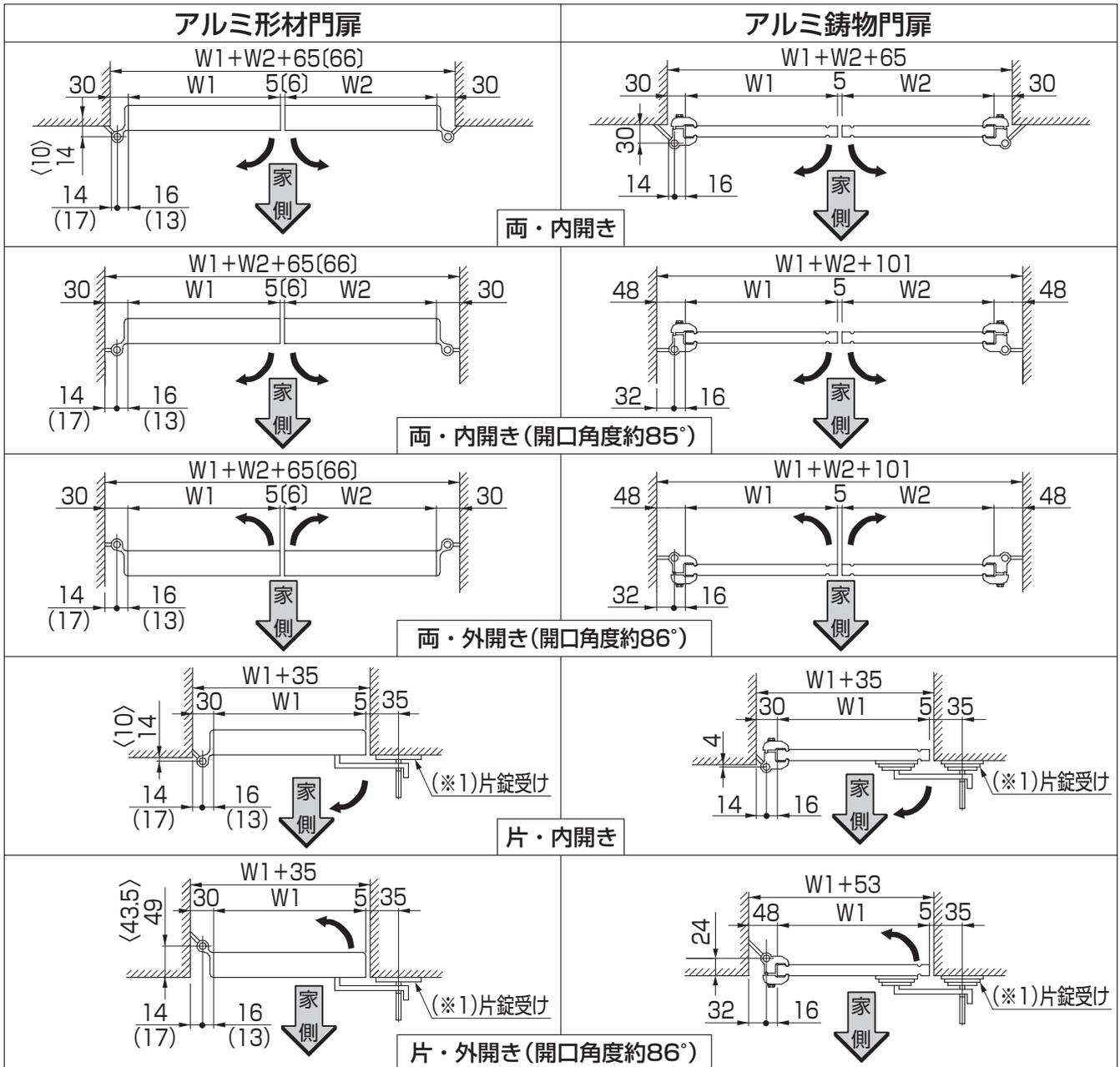
※1 片錠受けの取付けは、門扉を吊り、片錠受けの位置を合わせて孔をガイドにして、φ8.5の孔を25mmの深さまであけてプラグボルトを挿入し、M5×40サラネジで取付けてください。
