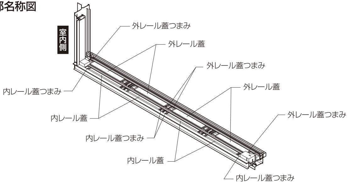
●2枚戸同様、内レール蓋・外レール蓋を外して清掃します。
