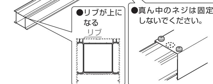
2: 連結スリーブを残りのネジ穴を使用して150角フレームに【4b】で固定
