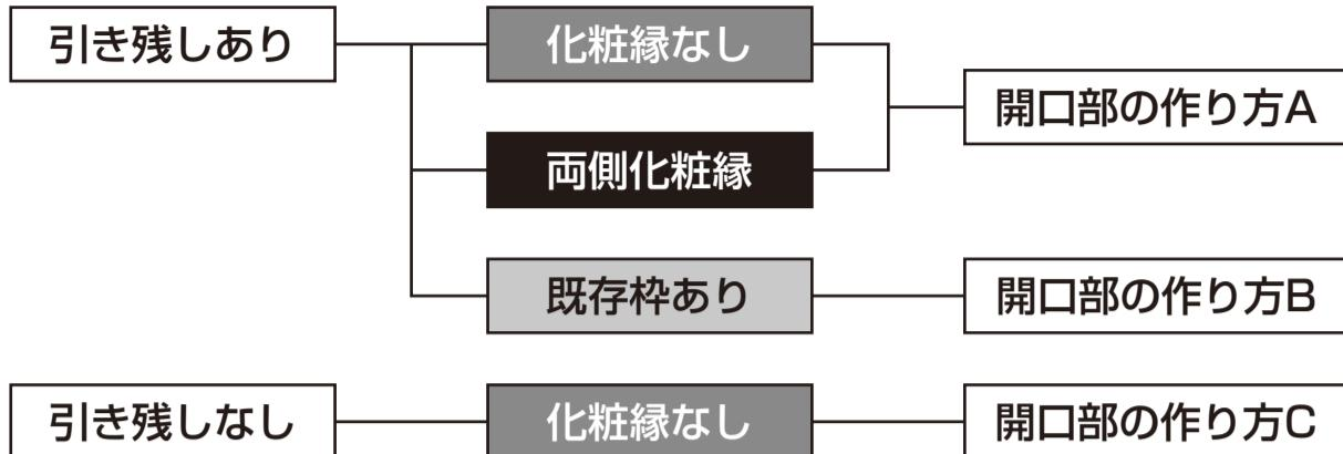
①納まりに応じて開口部を以下の通り作成(リフォームの場合は確認)してください。(図は右吊仕様を室外側から見た形を示します。)
