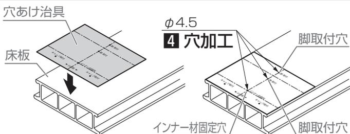
5:床板の長さに応じて、中央に穴あけ治具を用いてφ4.5の下穴加工
