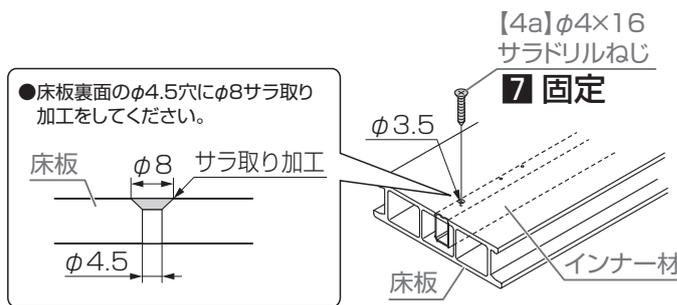
8:7と同様に、その他のインナー材固定穴からインナー材にφ3.5の下穴加工し、【4a】で固定
