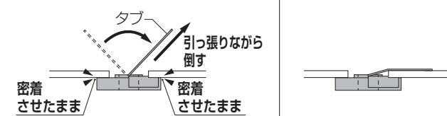
●引っ張り方が中途半端な状態では、ナット部が引っ掛け部と共に空回りして、ねじが締められなくなります。
