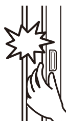
縦枠と引戸のすき間
