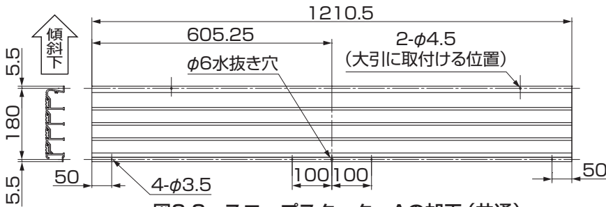
図3-3 スロープスターターAの加工(共通)
