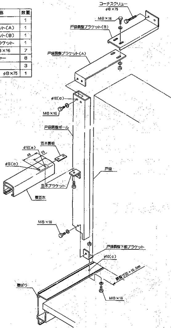
戸袋の位置や、大きさによって、加工寸法が違って来ますので、現場の寸法を確認の上、妻笠木・妻ばり・妻ばり格子パネル・戸袋調整ポールの加工をして下さい。
