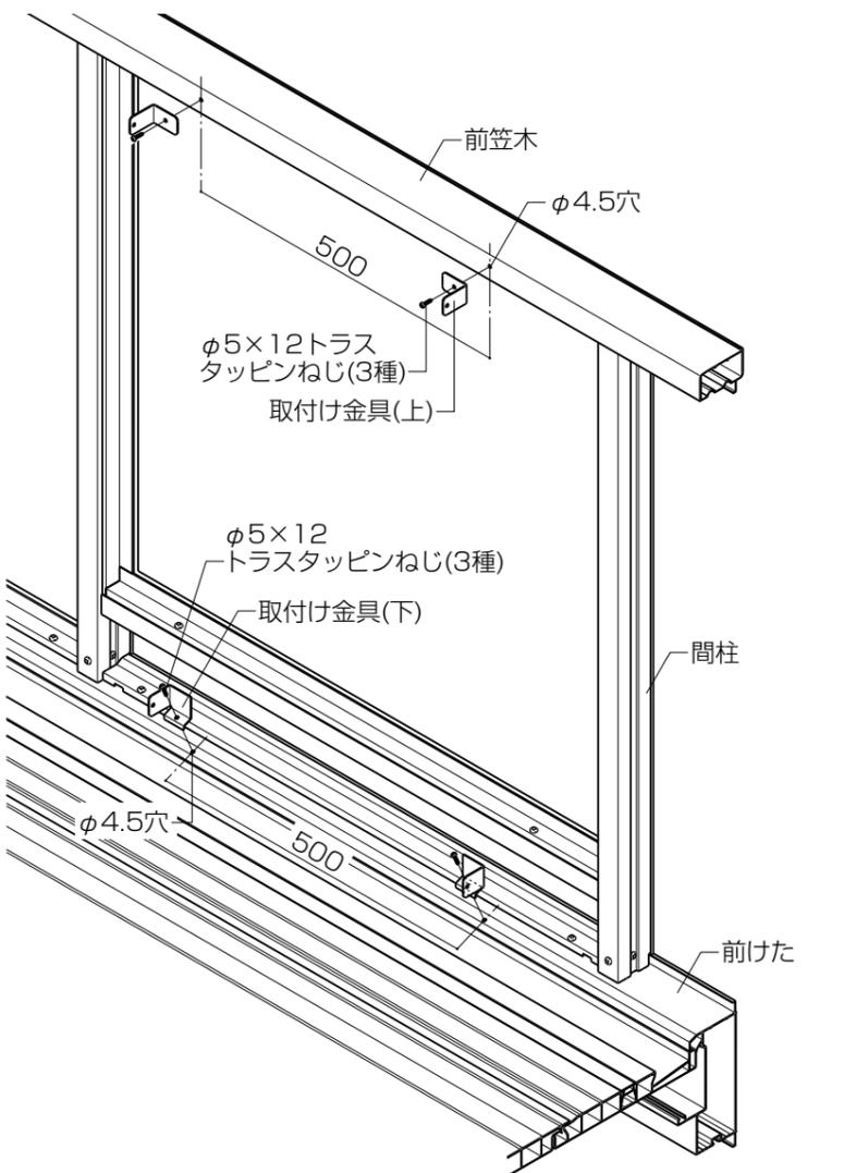
②取付け金具(下)と取付けサポートを仮止めし、取付け金具(上)の写し穴(φ4.5)を取付けサポートのV溝に合わせてあけ、ねじ止めします。
