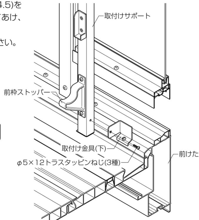
③仮止めのねじをすべて固定し、アダプターを取付けサポートに固定します。
