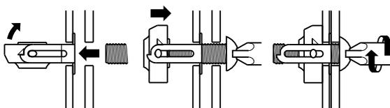
●ターンナットを下穴に挿入し、軽く押し込みながら締付けてください。
