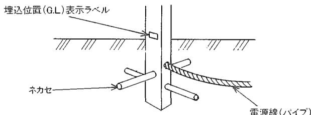
配線工事は必ず第3種接地工事を施してください。
