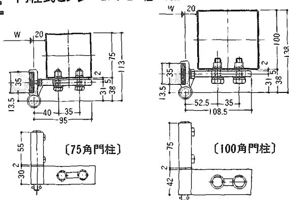
**F 直付調整式ヒンジ ヒンジピン径: 10mm**
