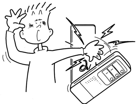
電気錠操作器本体は取付金具からはずさないでください。高圧電流が使われておりますので感電の危険があります。
