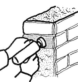
③タイル張り用振動機（ビブラート）を用い、目地のモルタルが盛り上がるまで十分に圧着します。
