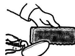
②ブリックの裏面に張り付けモルタルを1~2mm厚に塗ります。
