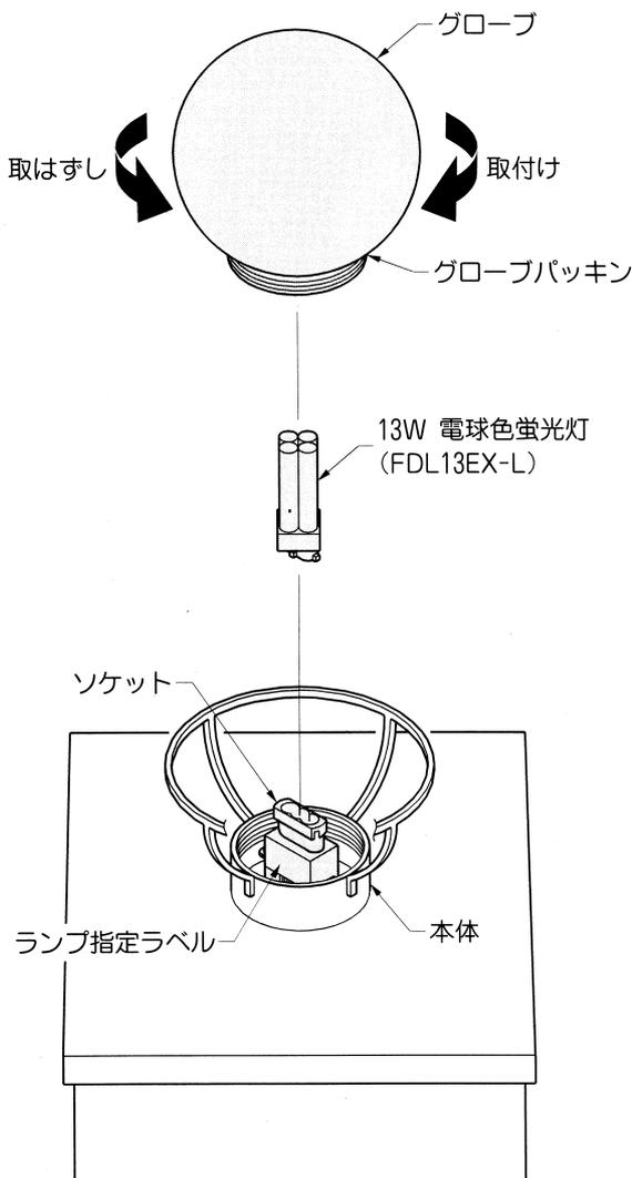
①グローブを反時計方向(↺)へまわして取はずします。
