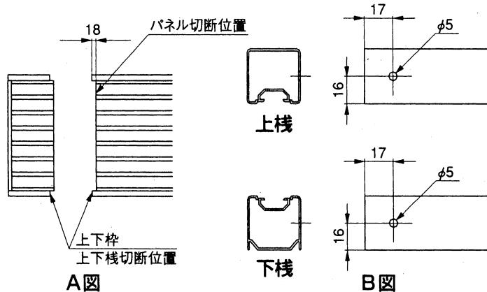
① 本体の上下桟・上下枠・パネルをA図の位置で切断してください。
