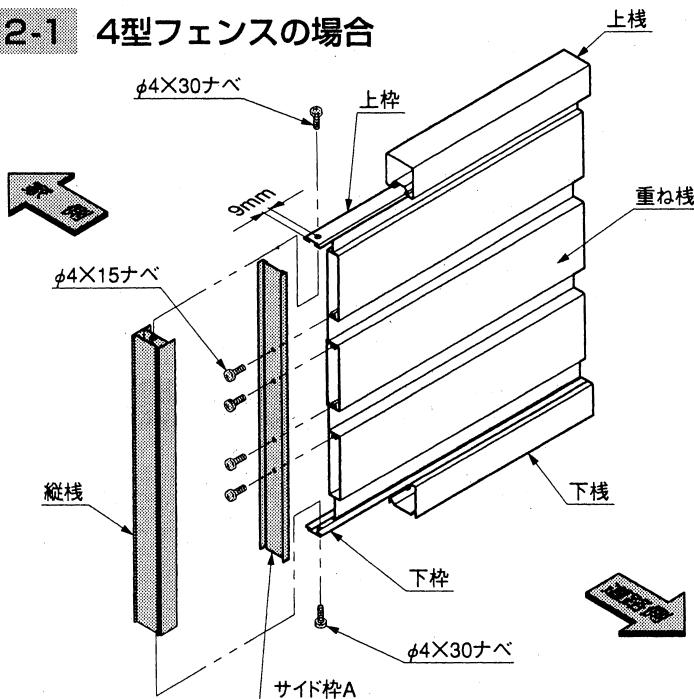
① 重ね桟にサイド枠Aを $\phi 4\times 15$ ナベで組付けてください。
