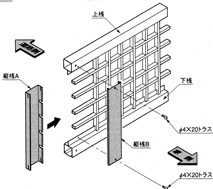
① 縦桟Aを差し込み縦桟Bでふたをした後、 $\phi 4\times 20$ トラスで組付けてください。
