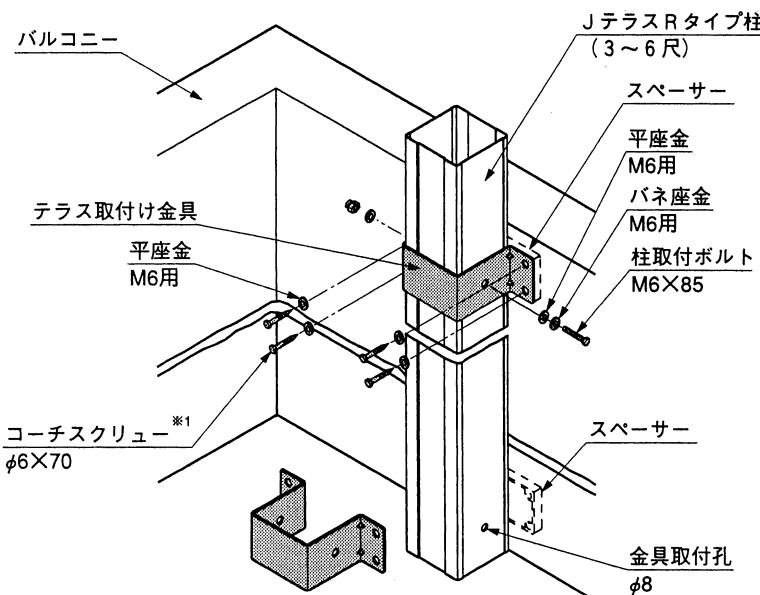
① テラスの柱に金具取付孔  $\phi 8$  を貫通であけください。
