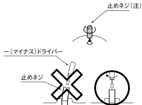
注意) 止めネジは、垂直にゆるみがないようにネジ込んでください。ななめにネジ込むと破損の原因となります。
