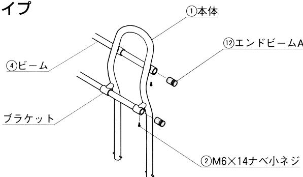
①エンドビームをブラケットに差し込み M6×14ナベ小ネジで確実に固定して下さい。
