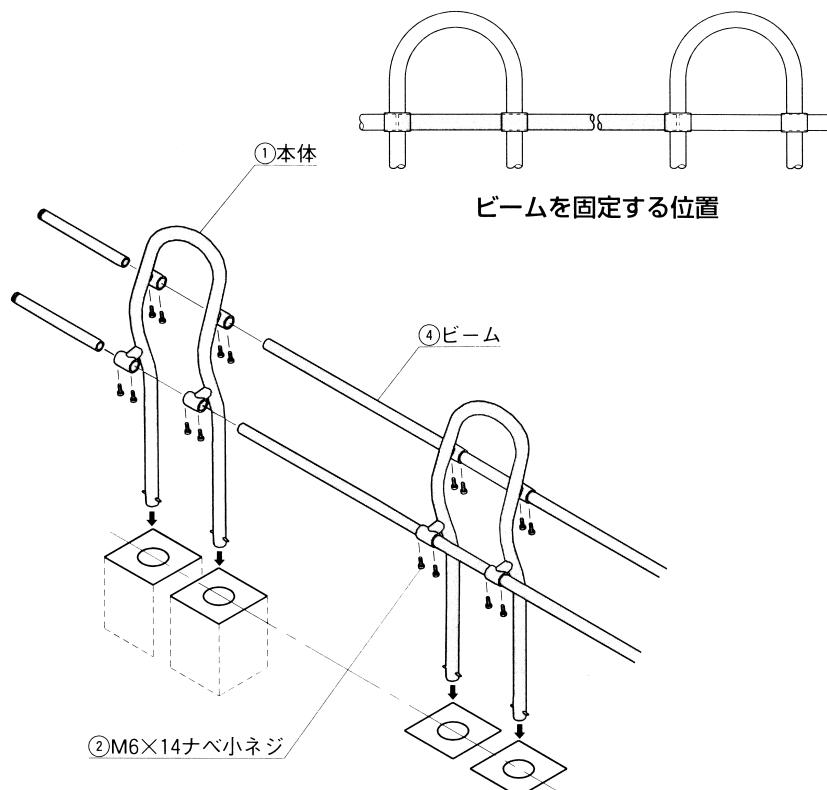
①施工図で示してあるピッチで、□300×400の基礎を設置します。
