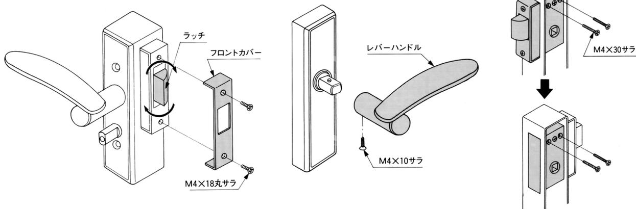
A図：ラッチの変更      B図：レバーハンドルの変更      C図：ラッチ錠ボックスの変更
