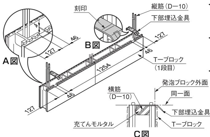
① 1段目のブロックのA図の位置に下部埋込金具取付け用の切り欠きをあらかじめ加工してください。
