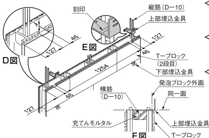
① 2段目のブロックのD図の位置に上部埋込金具取付け用の切り欠きをあらかじめ加工してください。
