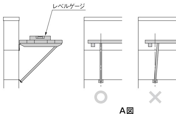
① テーブルの取付位置を調整するために、一度テーブルを引き上げて「テーブルを使用する状態」にしてください。
