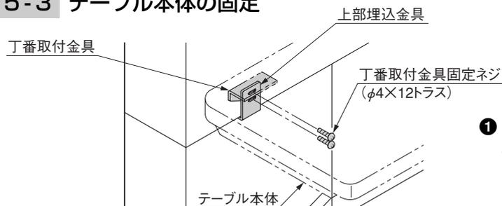
① 上部埋込金具と丁番取付金具を丁番取付金具固定ネジ(φ4×12トラス)で固定してください。
