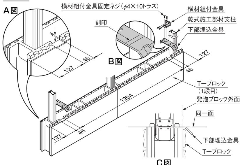
① 1段目のブロックのA図の位置に下部埋込金具取付け用の切り欠きをあらかじめ加工してください。
