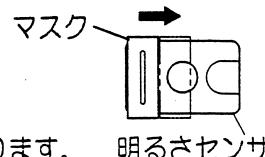
明るセンサのマスクを中央寄りに少しずつスライドさせ、入射光の量を調整してください。
