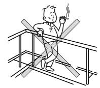
● 製品上で火気を使用しないでください。歩道板に火気を近づけると部材が変型・破損するおそれがあります。
