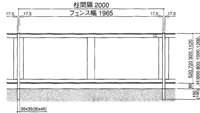
**注意** 風当りの強い場所に目隠しタイプのフェンスを設置する場合は柱間隔を1m以内にしてください。
