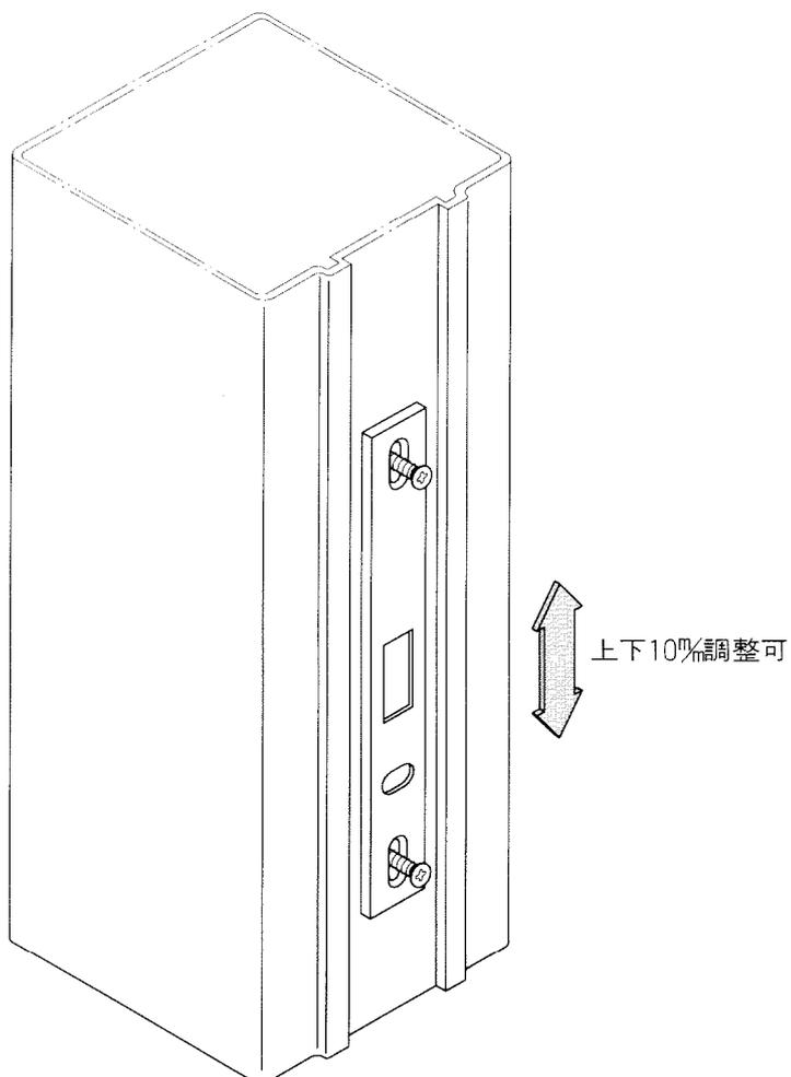
施錠合わせ等高さ調整が必要な場合には、施錠受けの取り付けビスをゆるめ調整後固定してください。
