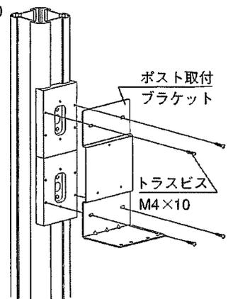
③ポスト取付ブラケットにポスト内側よりトラスビス4×10にてポストを取付け低面をM5用袋ナットとトラスビス5×8にて固定して下さい。
