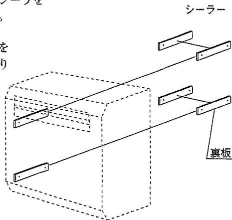
③ポスト取付けブラケットを取付けて下さい。
