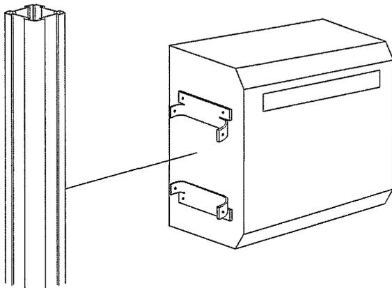
⑤ポスト取付ブラケットをテクスビス4×25にて柱に固定して下さい。
