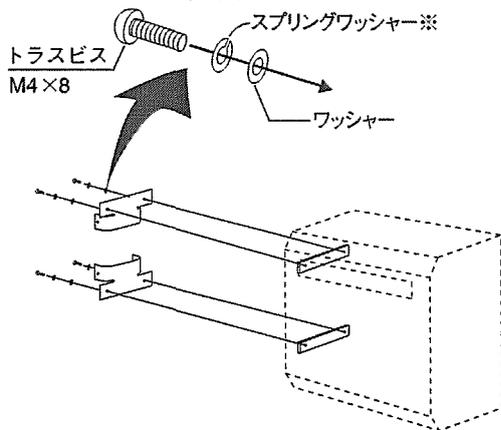
① TA型取付けの際はスプリングワッシャーを1枚除いて取付けて下さい。
