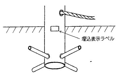
④ 電源線を口出し線と接続してください。自己融着テープにて防水処理を行なってください。
