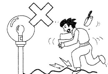
ケーブル線を引っ掛け、絶縁不良・けが・ケーブル線の損傷の原因になります。
