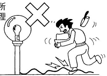
ケーブル線を引っ掛け、絶縁不良・けが・ケーブル線の損傷の原因になります。
