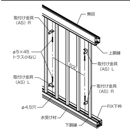
②FIX下枠部の取付け金具（土間・床）と取付けサポートを仮止めし、無目部の取付け金具（土間・床）との写し穴（φ4.5）を取付けサポートのV溝にあわせてあけ、ねじ止めします。
