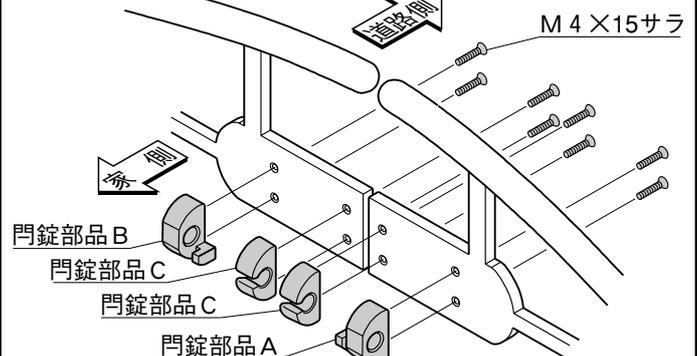
■イリス門扉 3 型の場合門錠取付ビス B (M 4 × 15 サラ) を用いて、上図の様に部品を取付けて下さい。
