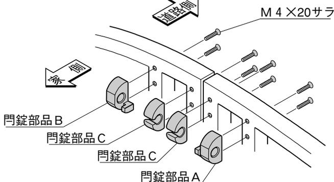
■イリス門扉 1・2・4 型の場合門錠取付ビス A (M 4 × 20 サラ) を用いて、上図の様に部品を取付けて下さい。
