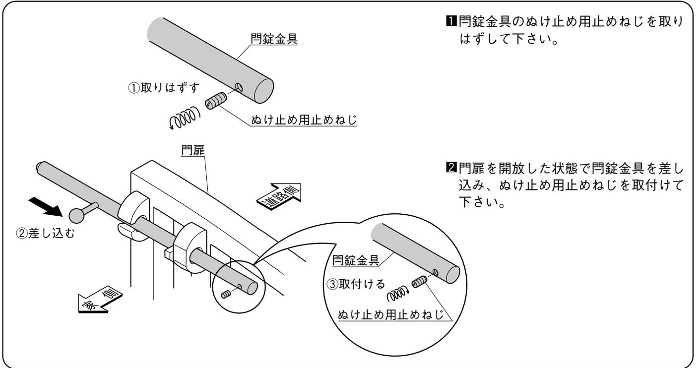
❶ 門錠金具のぬけ止め用止めねじを取りはずして下さい。
