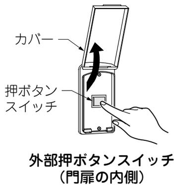
b.外部押ボタンスイッチを使う場合は、カバーを上げ押ボタンスイッチを押して施錠します。
