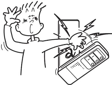
● 電気錠操作器本体は取付金具から外さないでください。高圧電流で感電するおそれがあります。
