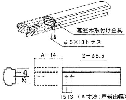
袖部から笠木を取り外してください。笠木を戸箱側から切断、孔あけ加工をし、妻笠木取付け金具を付け替えてください。
