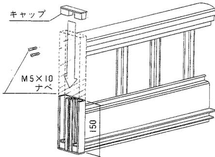
縦枠上部のキャップとビスをはずし、縦枠を切断したあと再びキャップを上からはめ込んでください。
