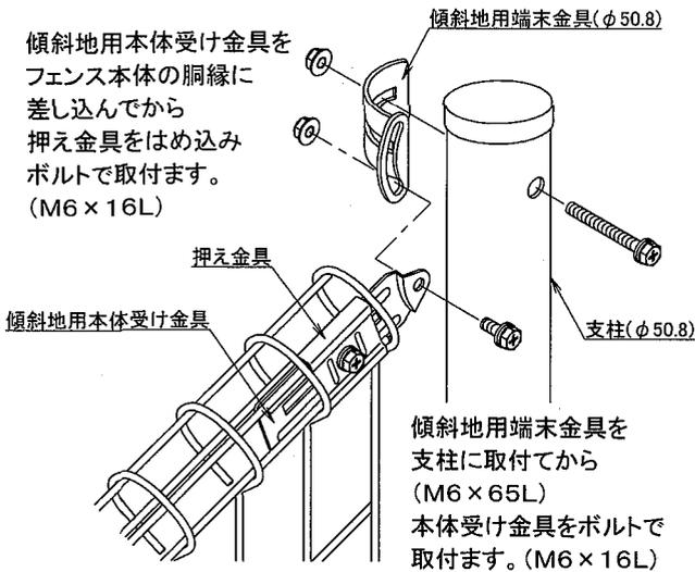
傾斜地用末端金具を支柱に取付てから(M6×65L)本体受け金具をボルトで取付ます。(M6×16L)
