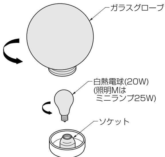
① ガラスグローブを反時計方向(  $\curvearrowright$  )へまわして取りはずします。
