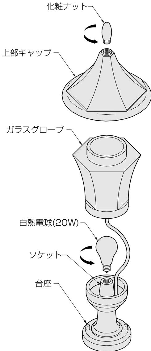
①化粧ナットをはずし、上部キャップおよびガラスグローブを台座からはずします。
