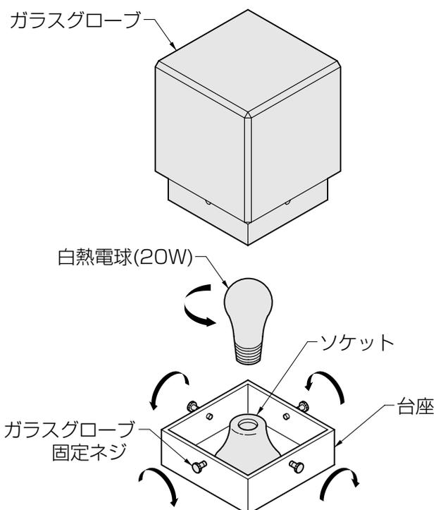
① ガラスグローブ固定ネジをゆるめ、ガラスグローブをはずします。
