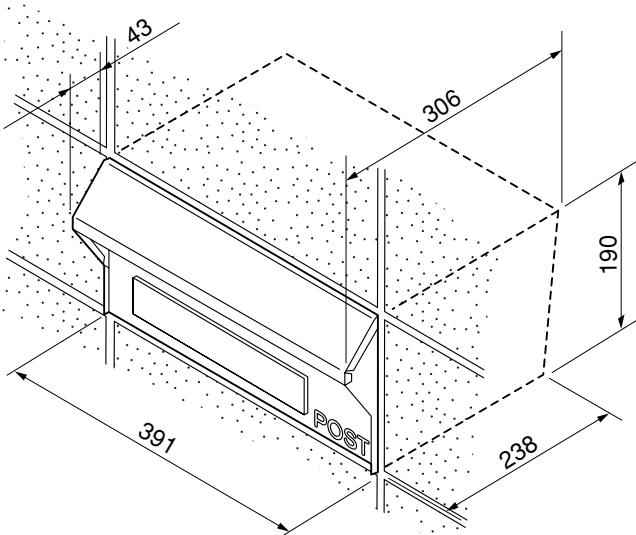
① ポストの外形寸法より10~20mm大きめの穴を壁にあけ、ポストを入れてください。
