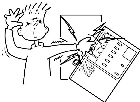
電気錠操作本体は取付金具からはずさないでください。高圧電流で感電する危険があります。
