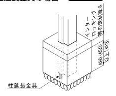
●門柱に補助アンカーを通し、固定してください。
