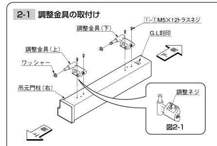
● 吊元門柱に調整金具(上)と調整金具(下)を固定してください。
