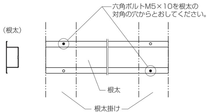
②根太の穴からとおした六角ボルトM5×10を平ワッシャーM5とナットM5で仮止めします。
