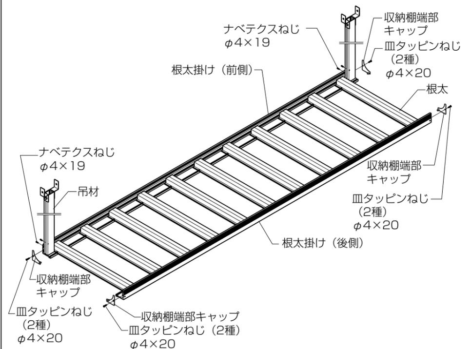
⑨上吊り棚セット2スパン用を幅方向に取り付けた場合で吊材を2本使用した場合は根太掛け(前側と後側)にあいたままになっている穴に同梱の穴ふさぎシール(φ15)を張ります。
