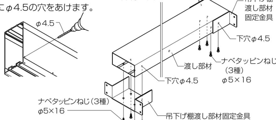
⑤吊下げ棚渡し部材固定部品を固定する際、はりの段差がある個所に取付ける場合は渡し部材取付けスペーサーを張ります。
