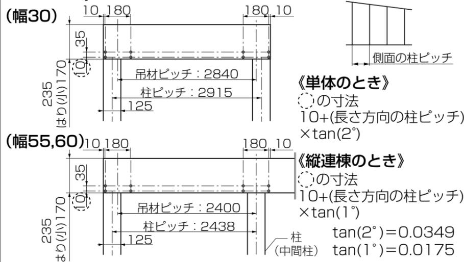
③はりに吊下げ棚渡し部材固定部品を取り付ける位置にφ4.5の穴をあけます。
