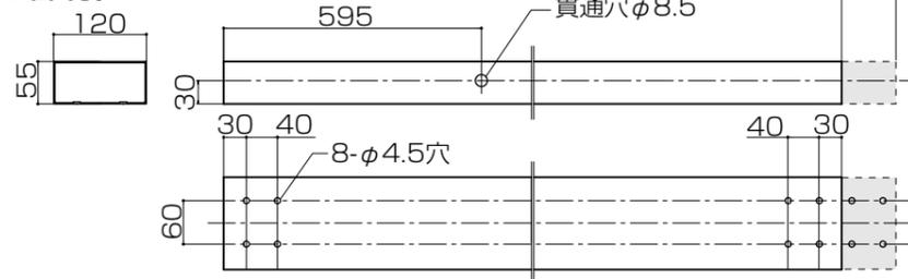
②はりに吊下げ棚渡し部材固定部品を取り付ける位置を決めます。
