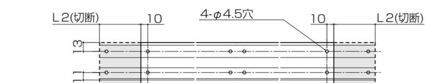
③ 2スパン用を幅方向30サイズに取り付ける場合の根太掛けの加工(L3=360)
