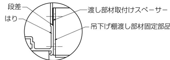
⑥はりに吊下げ棚渡し部材固定部品をナベタッピンねじ(3種)φ5×16で固定します。
