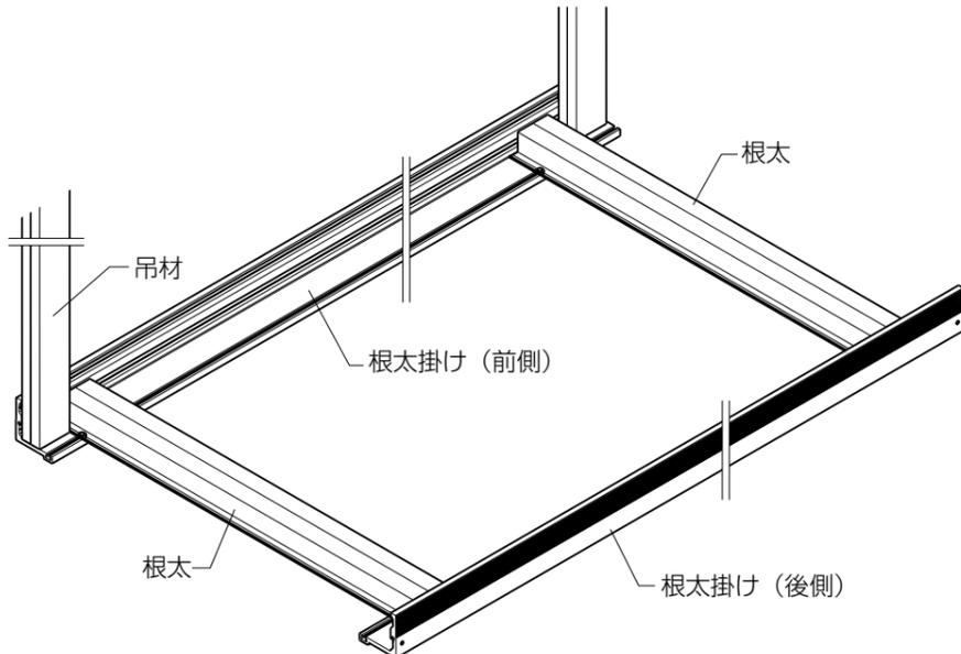
④2スパン用を側面に取り付けて吊材を3本使用する場合は中央の吊材の両端に根太をあてた状態でナットM5を本締めします。
