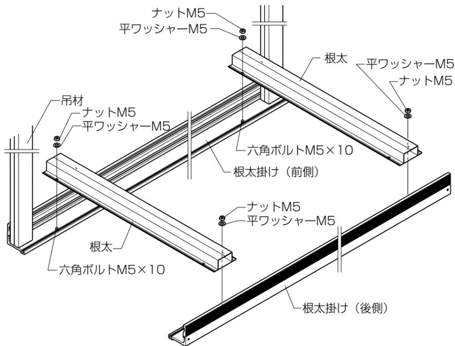
③両端の根太を吊材にあてた状態でナットM5を本締めします。
