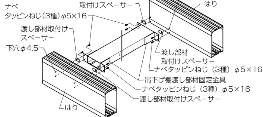
※以降の取付けは取付け手順（幅方向）の1 上吊り棚の組立て、2 根太の固定を同様に行います。
