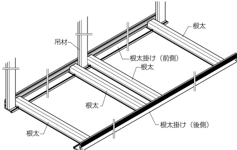
⑤残りの根太を両端からの間隔を測り、配置します。
