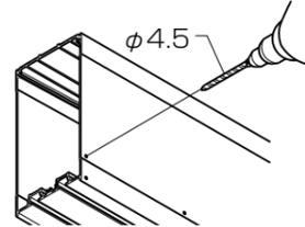
④吊下げ棚渡し部材固定金具を渡し部材に固定します。
