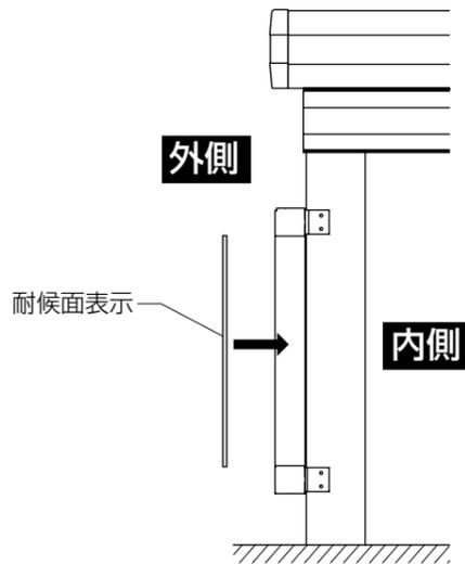
※パネルを組み込むときは耐候面の表示のある方が外側になるようにしてください。
