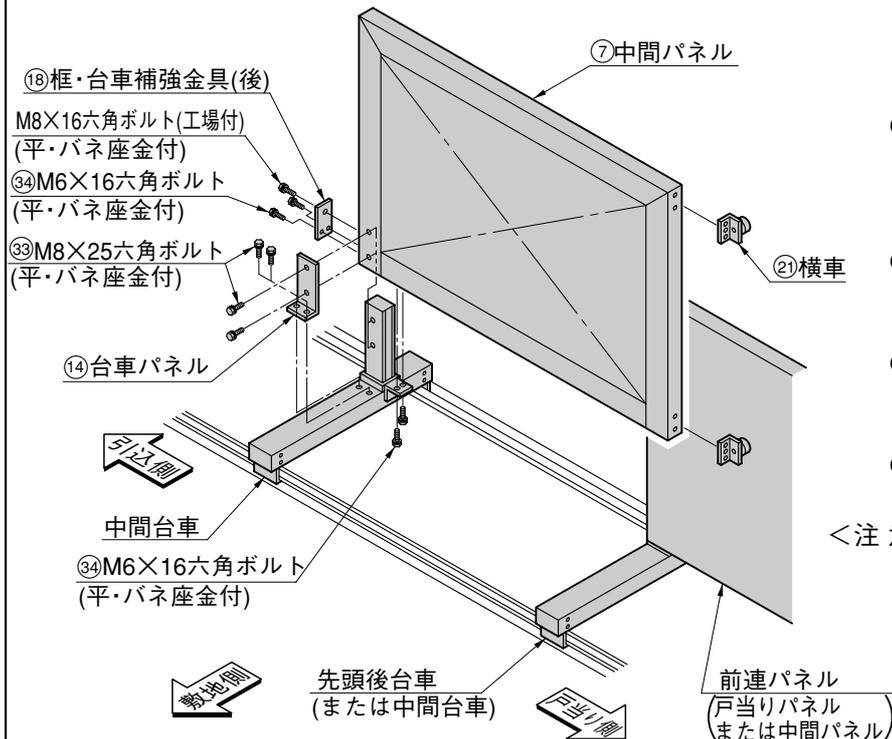
① 前連パネルの横車レールに横車を組付けてください。(詳細は、「7.横車と横車レールの組付け」を参照してください。)
