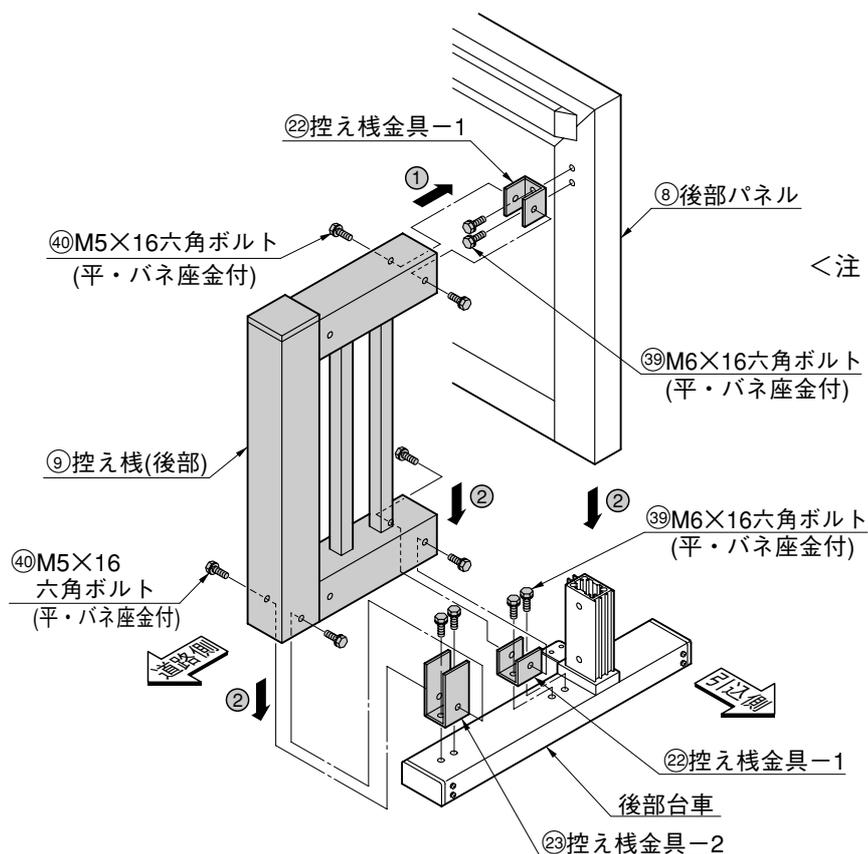
① 控え棧金具-1 をパネルに取付け、控え棧を組付けてください。(左図→①)
