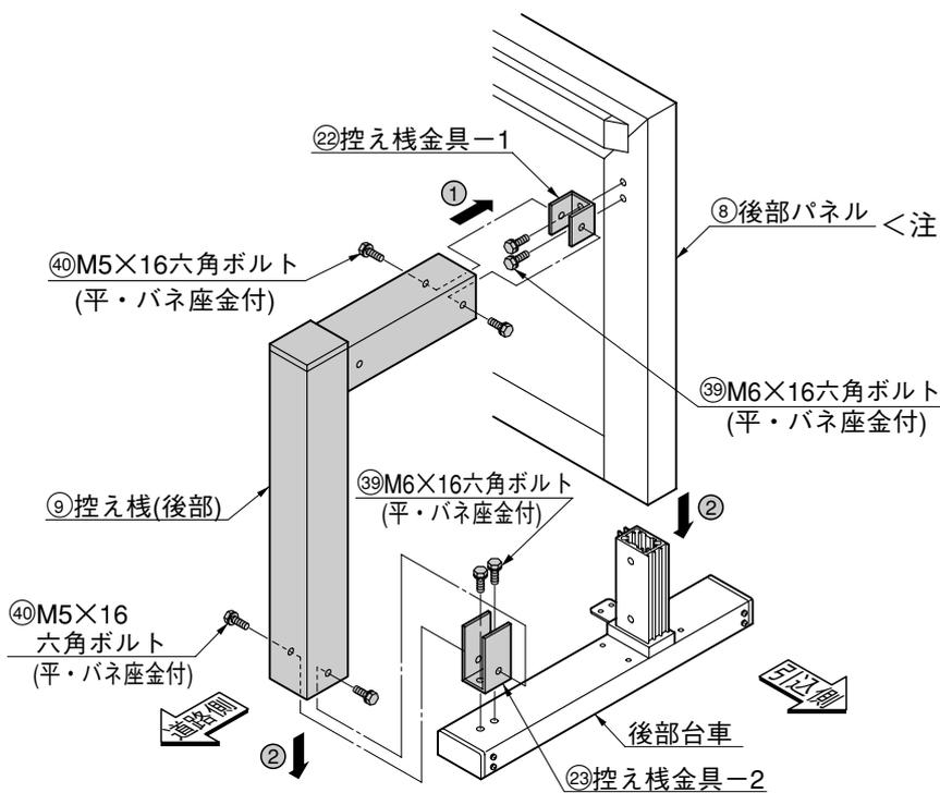
① 控え棧金具-1 をパネルに取付け、控え棧を組付けてください。(左図→①)
