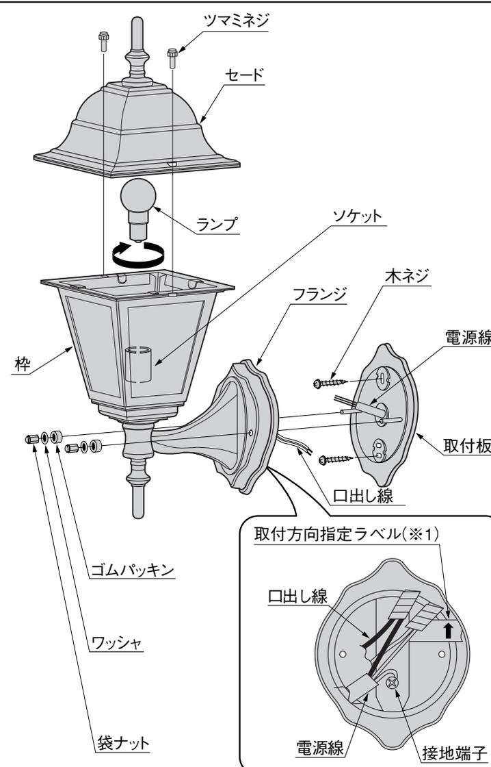
**①** 付属の木ネジ2本で取付板を壁面に取付けてください。
