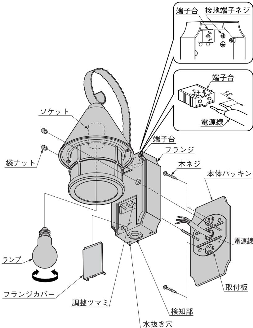
① 付属の木ネジ2本で取付板を壁に取付けてください。
