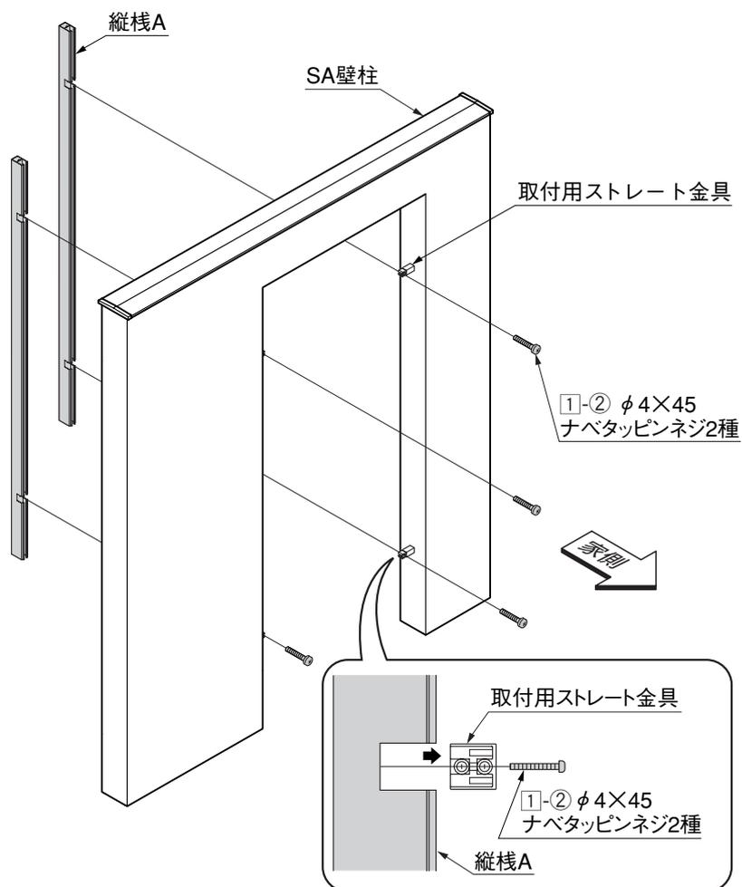
① 縦棧Aを取付用ストレート金具に1-2で取付けてください。
