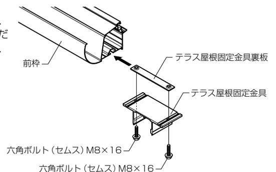
②前枠をはりにのせ、納まり図を参考に位置を決めます。はりに下穴をあけ、ボルトでテラス屋根取付け固定金具を固定してください。
