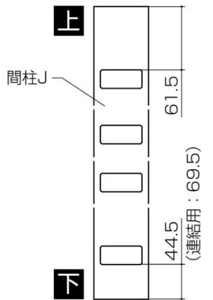
■間柱取付け金具取付け位置
