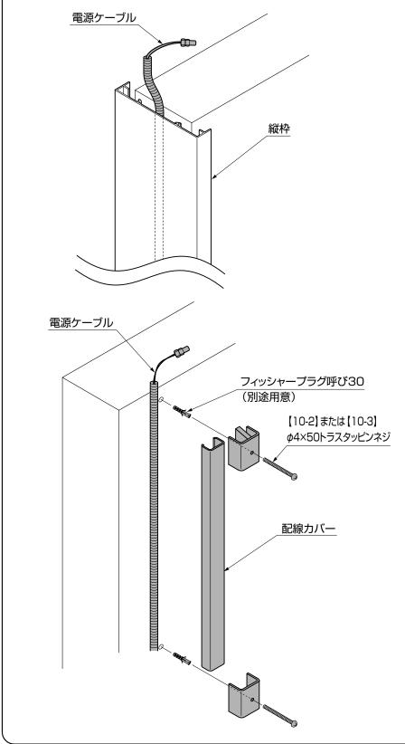
④電源ケーブルを露出配線する場合、縦枠内に納めるか、エクステリアライト用配線カバーで配線を隠してください。
