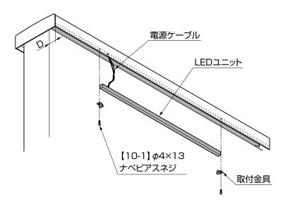
③LEDユニットを取付金具と【10-1】で 確実に固定してください。
