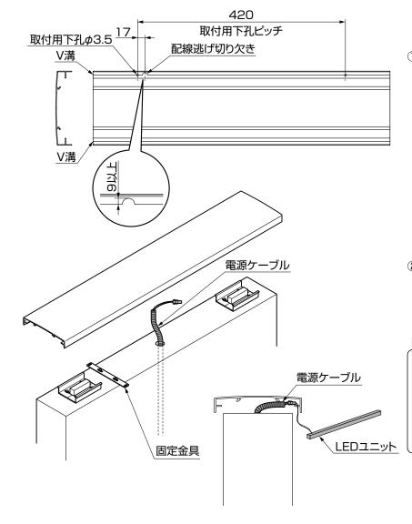
①コーピングのLEDユニットを取付ける 位置に取付け用の下孔 φ3.5と配線の逃 げ切り欠き加工をしてください。
